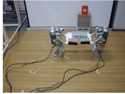
進化型ロボットの例：ヒューマノイドによる協調搬送
